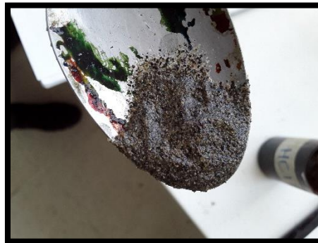
Figura 10. No efervescencia tras aplicar HCl a las muestras
