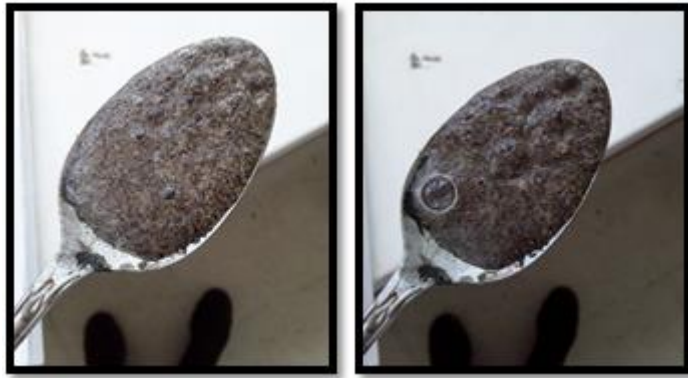
Figura 9. Efervescencia tras aplicar peróxido de hidrógeno a las muestras
